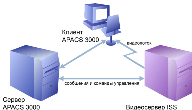
Рисунок Архитектура работы ПК APACS 3000 с оборудованием видеонаблюдения ISS
