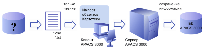
Рисунок Схема импорта информации в БД APACS 3000
