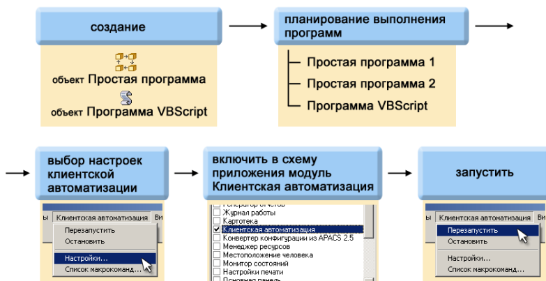
Рисунок Схема конфигурирования клиентской автоматизации
