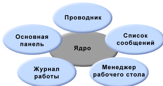
Рисунок Внутренняя структура ПК на клиентском уровне: ядро и клиентские модули
