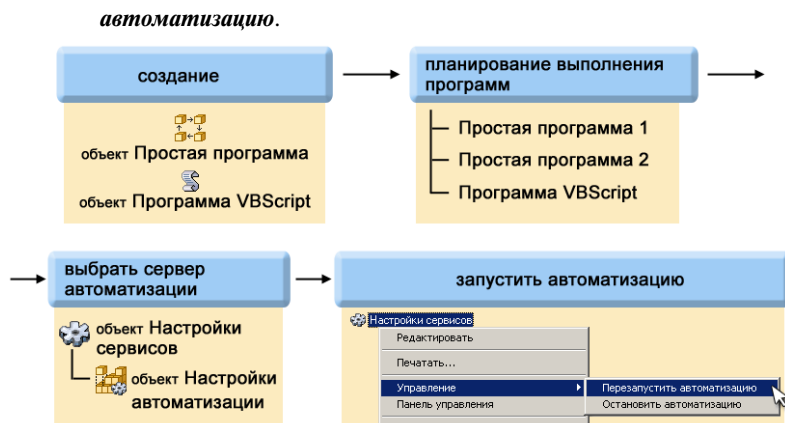
Рисунок Схема конфигурирования серверной автоматизации
