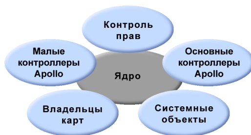
Рисунок Внутренняя структура ПК на серверном уровне: ядро и серверные расширения
